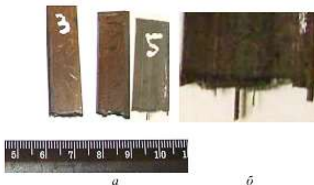
Рис. 3. Фрагменты углепластиковой конструкции адаптера (а); в нижней части образца № 5 видны волокна (б)
